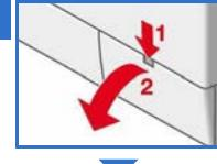
2. Для моделей со сливным шлангом: выньте сливной шланг из держателя и вытяните его из корпуса. Подставьте под него какую-нибудь ёмкость. Снимите колпачок, дайте стечь мыльной воде. Наденьте заглушку и поместите сливной шланг в держатель.
