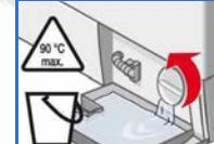
3. Осторожно отверните крышку насоса (остаточная вода!).
